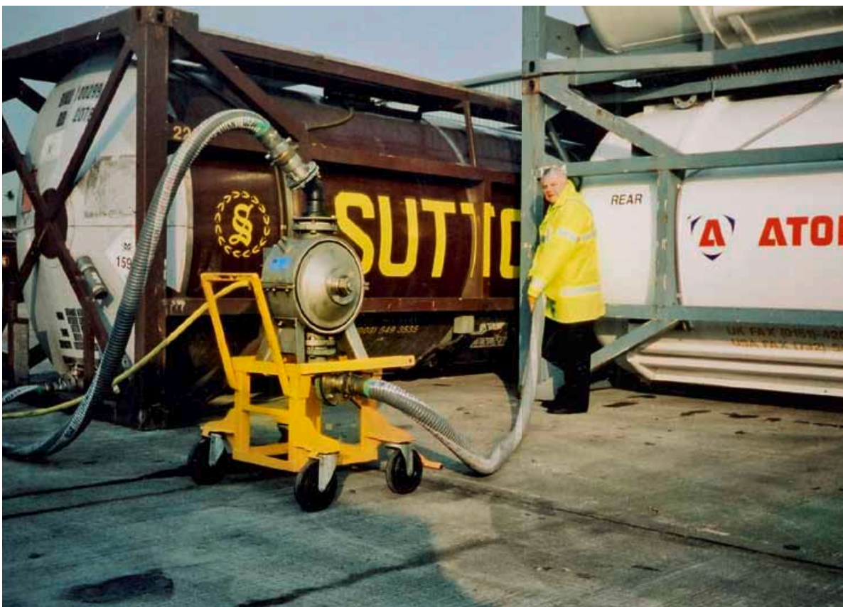
Die Pumpe befördert verschiedene Flüssigkeiten, z.B. Diesel. Sie ist in der Lage, einen 30.000 Liter fassenden Tank in weniger als zwei Stunden zu entleeren.
